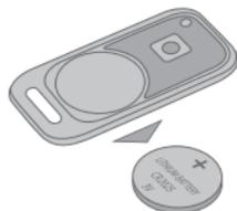
2) Mantenga presionado el botón del mando y coloque la batería. El LED del mando se iluminará en rojo.
